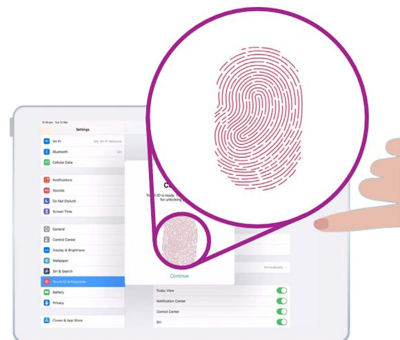
Pulse y levante varias veces el dedo del botón de "Inicio". El escaneo ha finalizado cuando la huella de la pantalla se ha puesto completamente en rojo.
